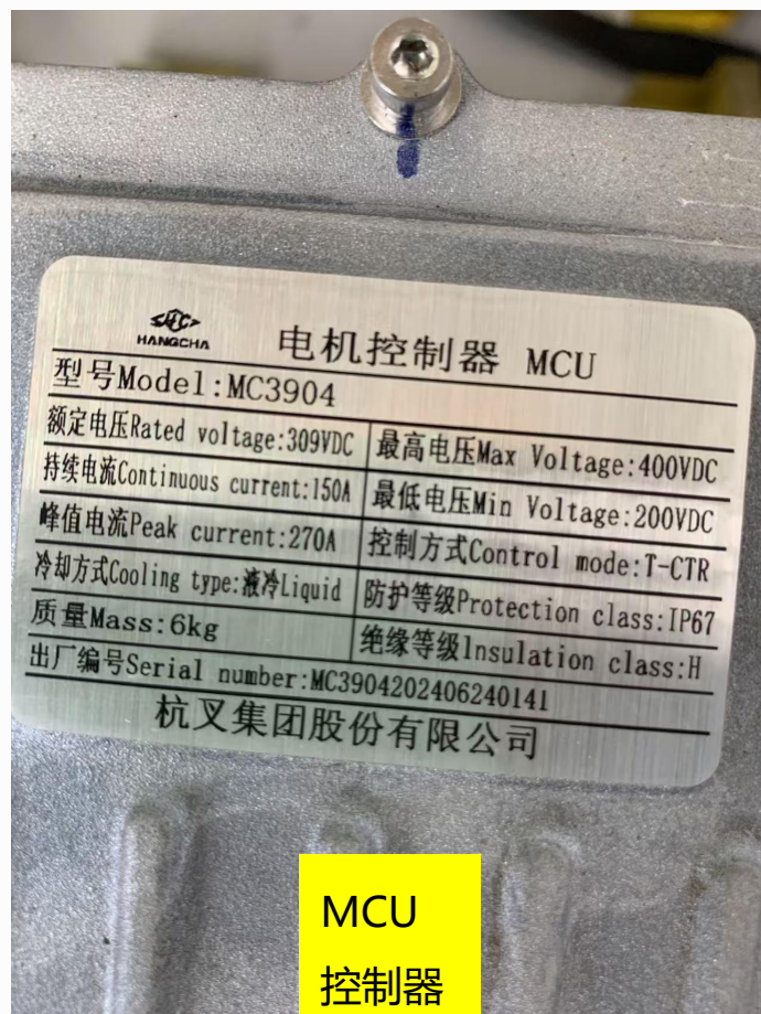
MCU: Motor Control Unit / 电机控制器
