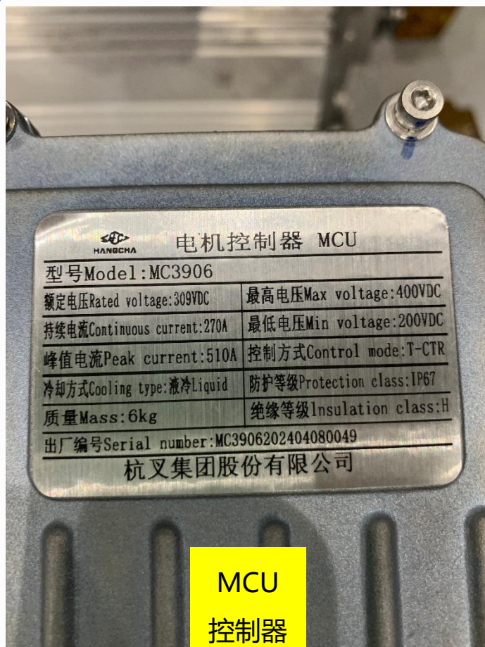
MCU: Motor Control Unit / 电机控制器
