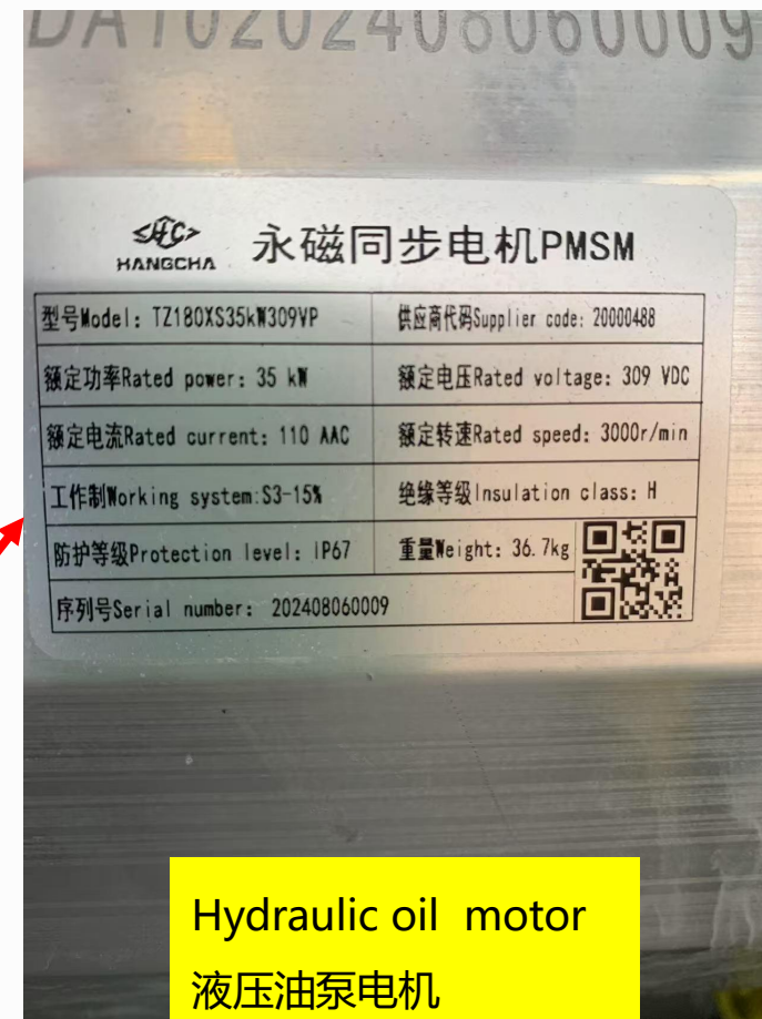
PMSM: Permanent Magnetic Synchronize Motor / 永磁同步电机
